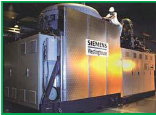
Resim 6.12. Siemens- Westinghouse ait gaz türbinini destekli SOFC prensipli elektrik üretici.
