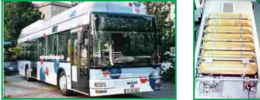
Resim 6.19. MAN modeli ve tavana yerleştirilen Hidrojen tanklarının görünümü
